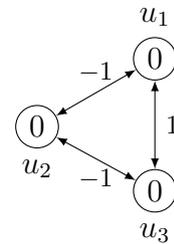
Hinweis: Verwenden Sie einen Zustandsübergangsgraphen. Markieren Sie in diesem Graphen Start- und Endzustand/Endzustände. Beachten Sie, dass es kein explizites Startneuron gibt und somit alle möglichen Folgezustände zu berücksichtigen sind.
